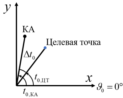
Рисунок 31 – Определение разницы фазового положения во времени между КА и целевой точкой
