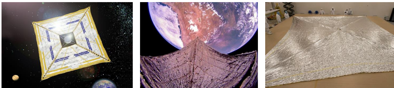
Рисунок 1 – Некоторые проекты СП: а) IKAROS; б) развёртывание LightSail 2 на околоземной орбите; в) развёртывание NEA Scout в лаборатории NeXolve
