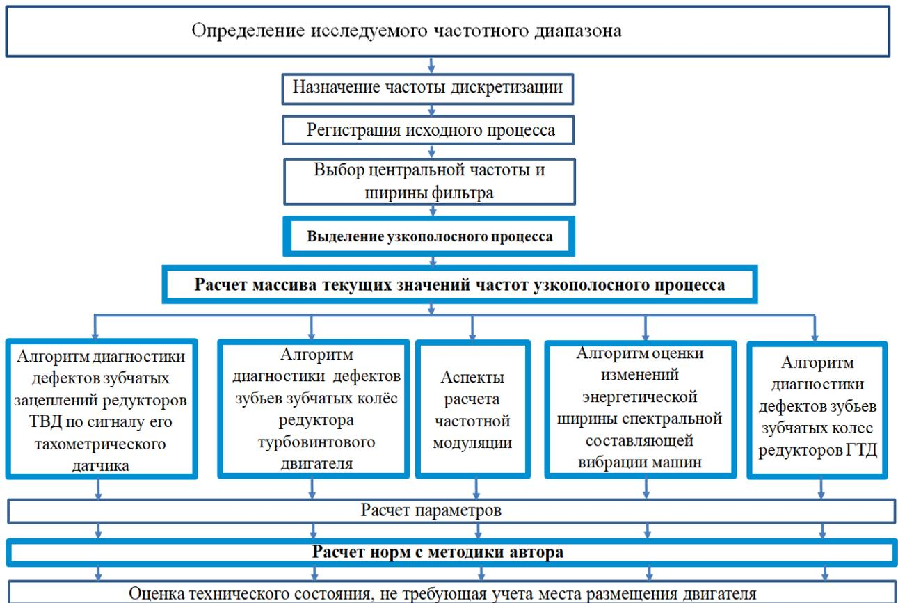
Рисунок 2.1 – Алгоритмы реализации метода устранения проблемы влияния перестановки двигателя со стенда
