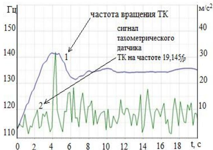
Рисунок 5.3 – 1 – частота вращения ротора ТК, 2 – интенсивность вибрации с кратностью 19,145
