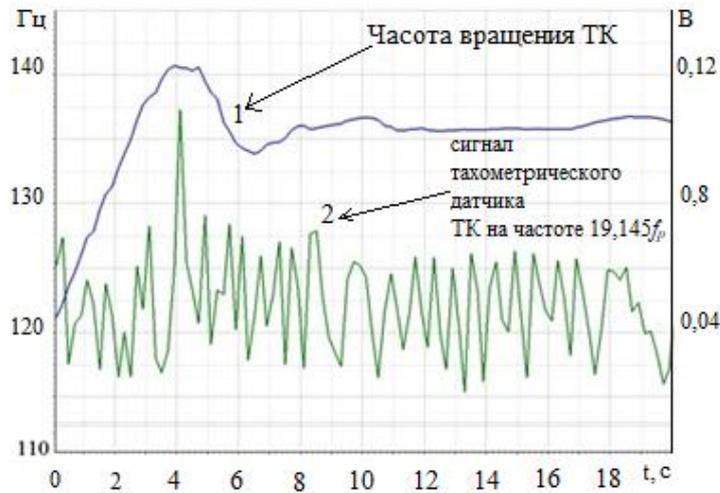
Рисунок 5.2 – 1 – частота вращения ротора ТК, 2 – интенсивность сигнала с кратностью 19,145 с датчика частоты вращения ротора ТК
