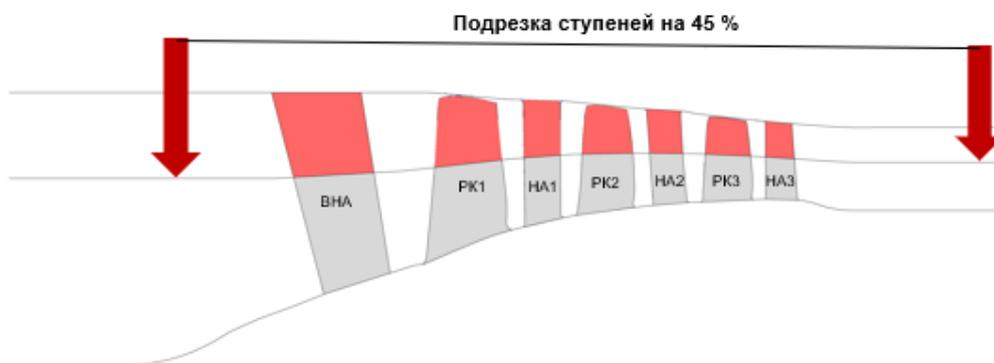
Рисунок 3.23 – Модификация пневмотормоза
