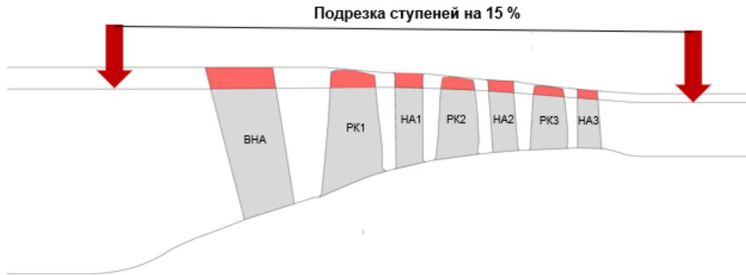
Рисунок 3.21 – Модификация пневмотормоза
