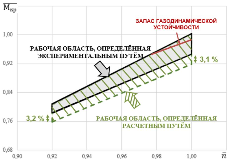
Рисунок 2.21 - Рабочая область пневмотормоза по параметрам  $\overline{M}_{кр}$  и  $\overline{n}$
