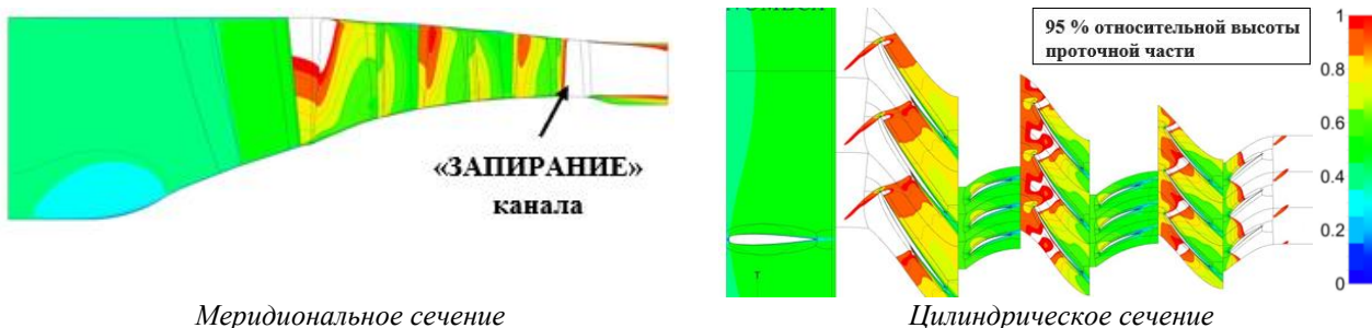
Рисунок 3 – Рассчитанные поля чисел Маха в относительной системе координат, полученные с помощью численной модели базового МОК в точке А (рис. 2)
