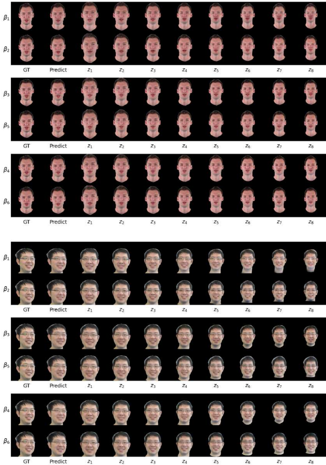
Рисунок А.37 – Результаты синтеза в зависимости от разного удаления головы от камеры. Верхняя строка каждого блока – результат синтеза изображений-проекций, где инициализация производится из параметров, полученных без применения исследуемой аугментации; нижняя строка каждого блока – результат синтеза изображений-проекций, где инициализация производится из параметров, полученных с применением исследуемой аугментации
