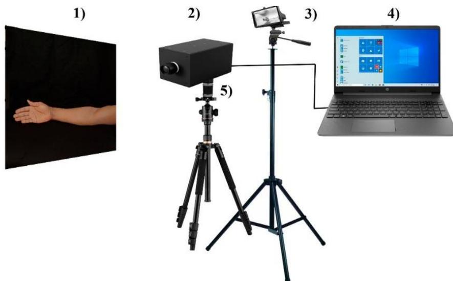
Рисунок 1 – Общая схема проведения съемки гиперспектральных изображений: 1) образец; 2) гиперспектрометр; 3) источник света; 4) компьютер; 5) поворотная платформа
