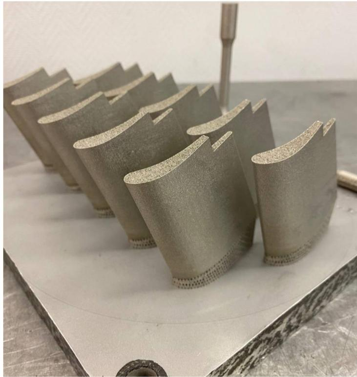
Рисунок 4.5 – Партия заготовок лопаток секции соплового аппарата турбины, изготовленных технологией СЛС с образцами свидетелями
