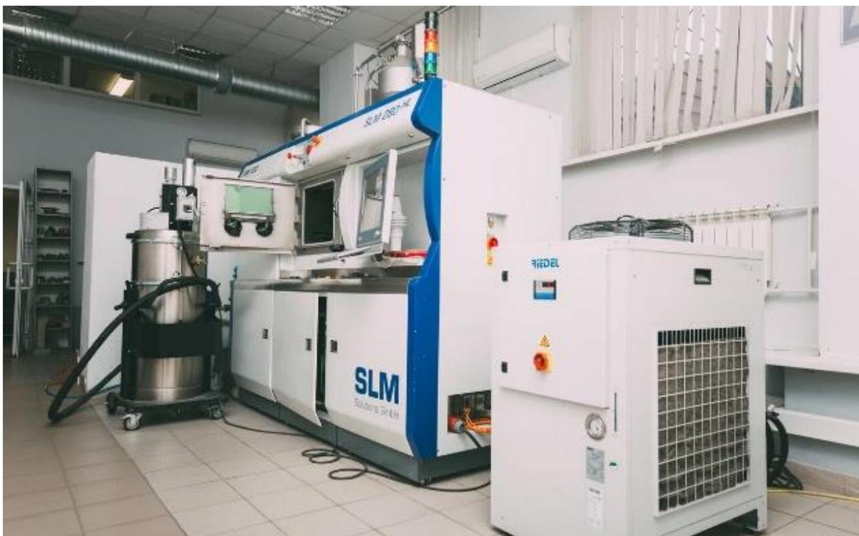
Рисунок 4.3 – Установка СЛС SLM 280HL
