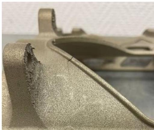
Рисунок 1.7 – Трещина, вызванная остаточными напряжениями
