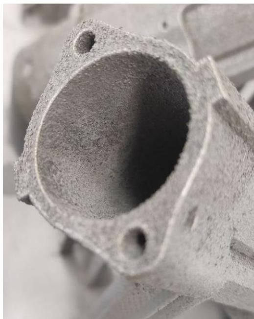
Рисунок 1.5 – Частицы МПК на поверхности алюминиевого сплава РС553
