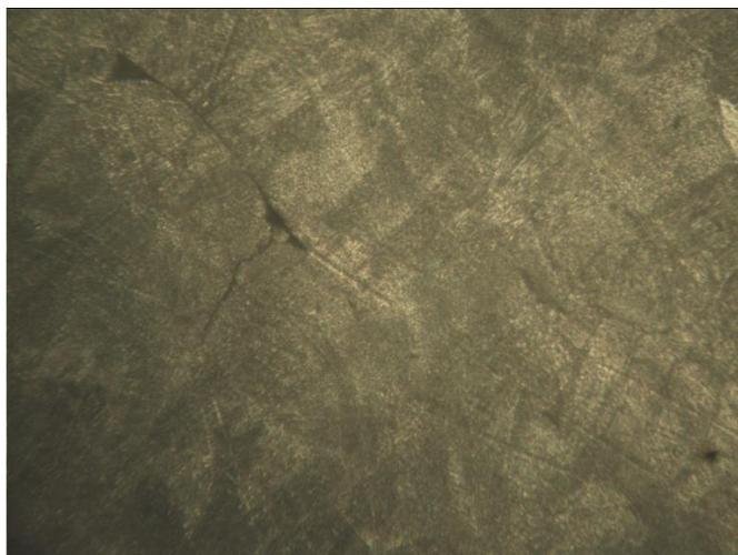
Рисунок 1.6 – Трещина, возникшая в процессе СЛС МПК ВВ751П
