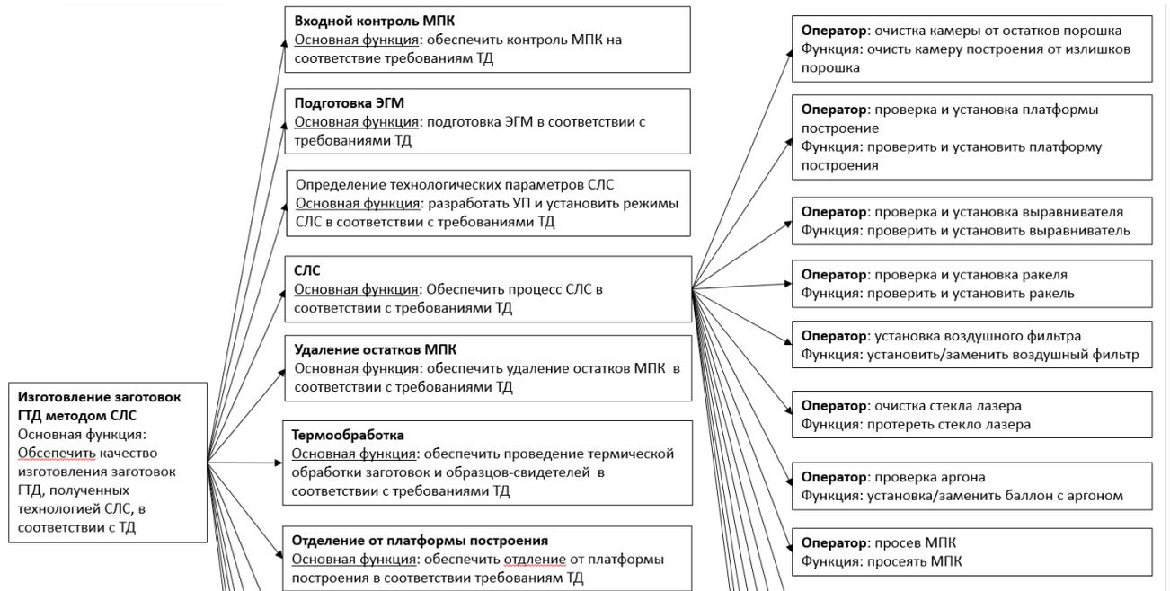
Рисунок 2.12 – Фрагмент дерева функционального анализа процесса изготовления заготовок технологией СЛС
