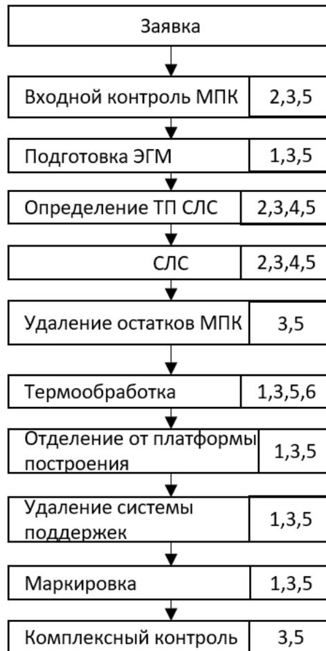
Рисунок 2.5 – Основные операции типового технологического процесса СЛС
