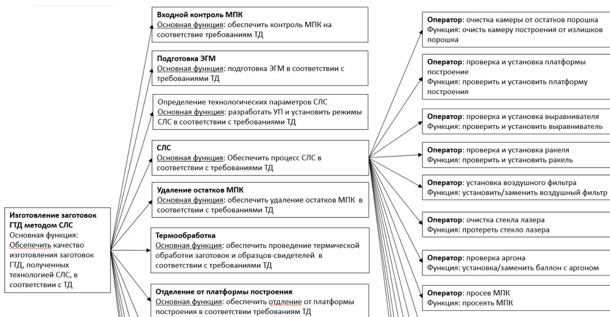
Рисунок 5 – Фрагмент дерева функционального анализа процесса изготовления заготовок технологией СЛС
