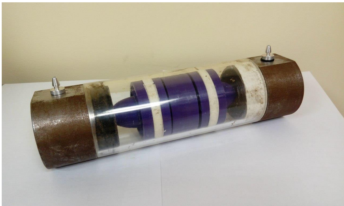
Рисунок 3.7 – Микротурбина ПТ диаметром 55 мм в корпусе
