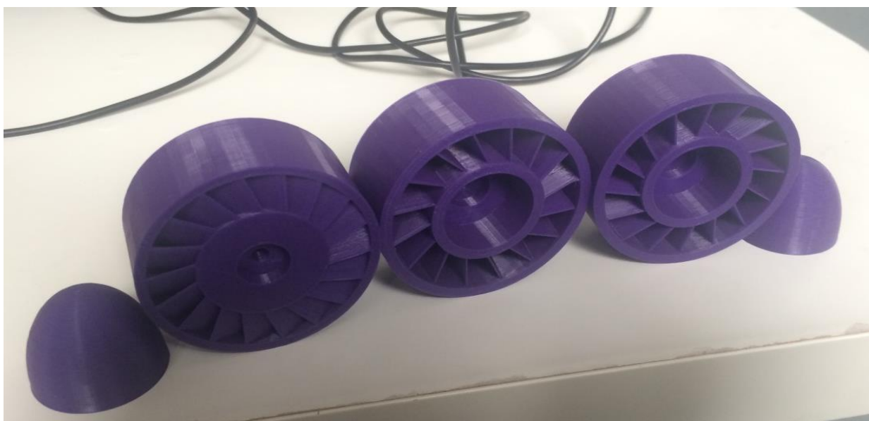
Рисунок 2.17– Изготовленная на 3D принтере модель пульсационной турбины
