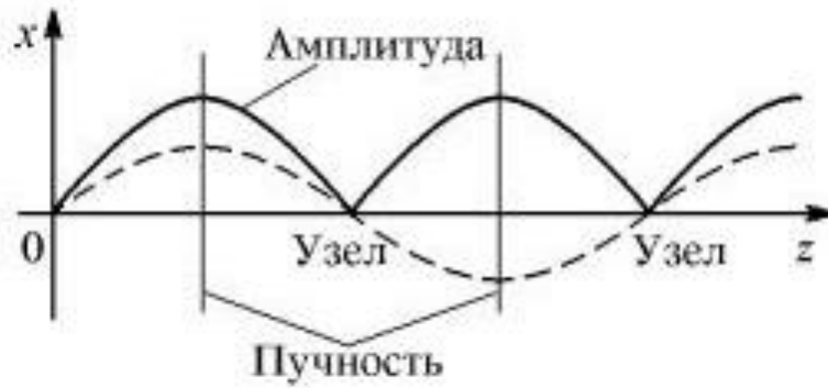
Рисунок 2.3 – Отображение узлов и пучностей стоячей волны
