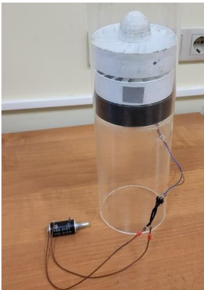
Рисунок 3.8 – Микротурбина ПТ диаметром 108 мм в корпусе
