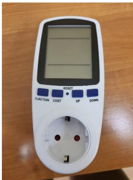
Рисунок 3.14 – Розетка-счётчик потребляемой электроэнергии
