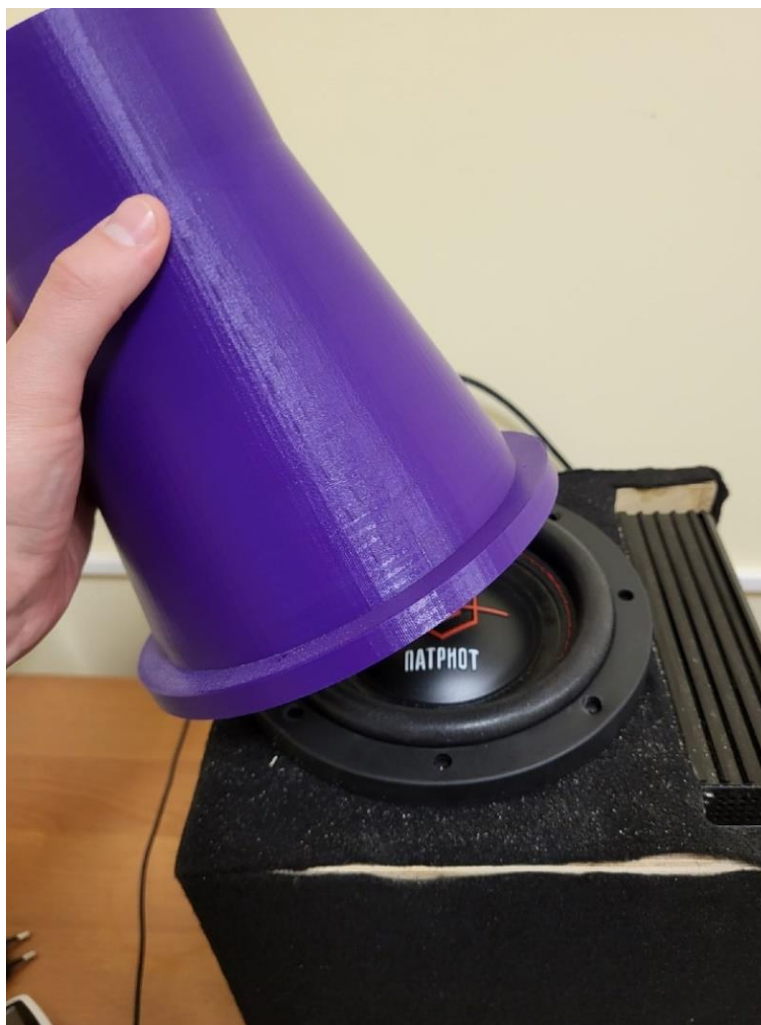
Рисунок 3.4 – конус перехода с динамика на волновод.
