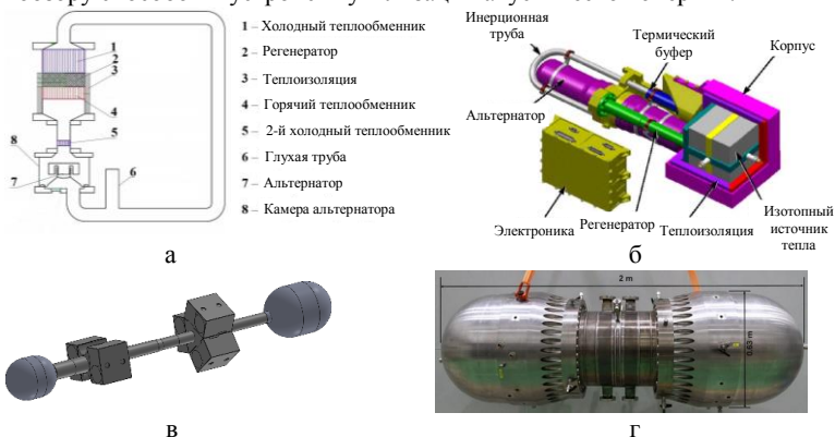
а – принципиальная схема ТАД; б - радиоизотопный ТАД фирмы Northon Grumman мощностью 128 Вт, разработанный для миссии на спутник Титан; в - радиоизотопный ТАД фирмы Nirvana Energy Systems мощностью 100 Вт для систем электропитания космических аппаратов; г - радиоизотопный ТАД разработанный учёными Технического института физики и химии при Академии наук Китая мощностью 102 кВт.
