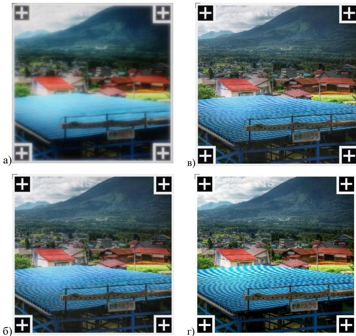
Рисунок 4.2 – Пример изображения из тестовой выборки: а) сформированное МДЛ ( $t=13$ ), б) восстановленное для монокулярное системы, в) восстановленное для бинокулярной системы, г) эталонное
