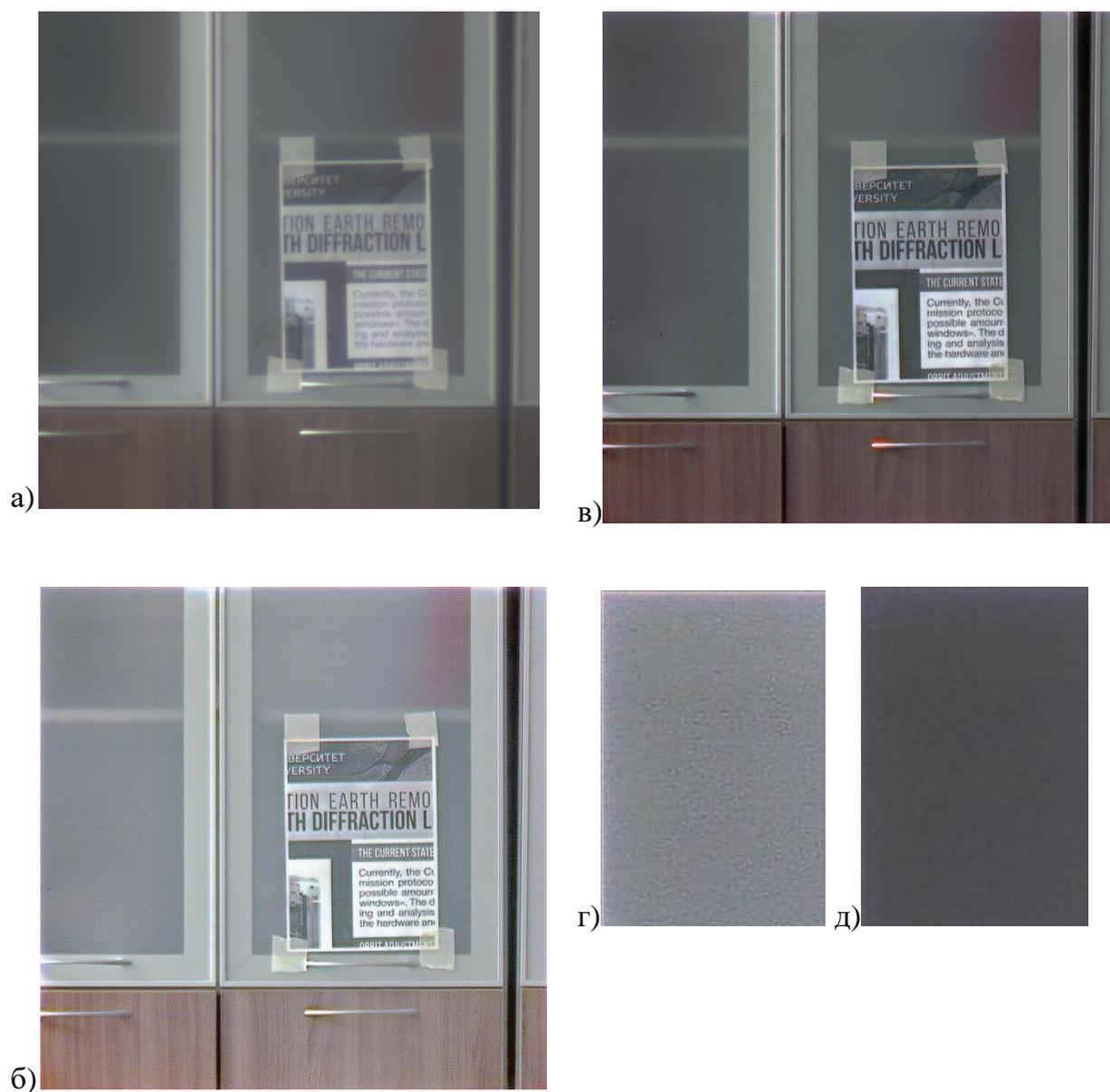
*Рисунок Б.2 – Результат реконструкции реального изображения, не участвовавшего в обучении: а) изображение, сформированное рефракционно-дифракционной ОС, б) случай без аугментации обучающей выборки, в) случай с аугментацией обучающей выборки (таблица 4.4 строка 4), г) фрагмент б), д) фрагмент в)*
