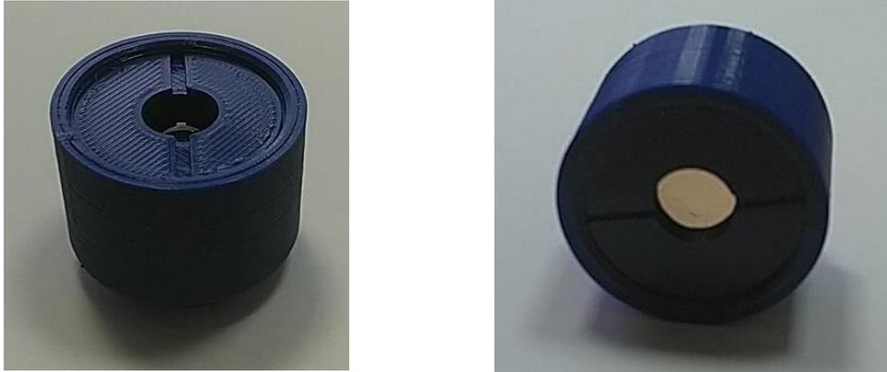
Рисунок 1.12 – Внешний вид рефракционно-дифракционного дублета
