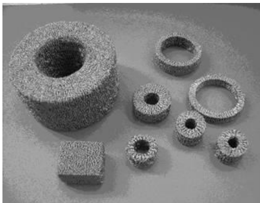
Рисунок 5 – Упругодемпфирующие элементы для виброизоляторов из материала МР различного типа [141]
