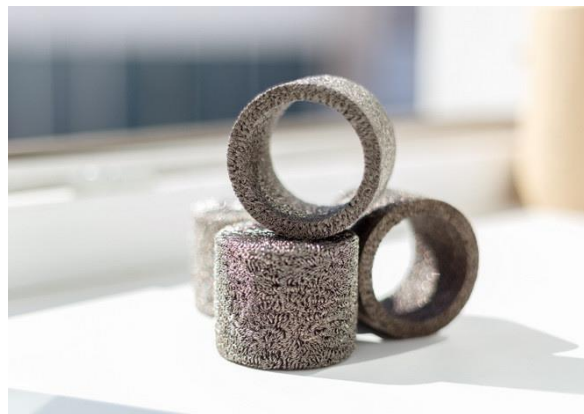
Рисунок 5 – Упругодемпфирующие элементы для виброизоляторов из материала МР различного типа [141]
