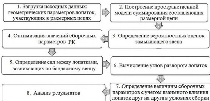
Рисунок 6 – Блок-схема алгоритма расчёта геометрических сборочных параметров венцов РК турбины
