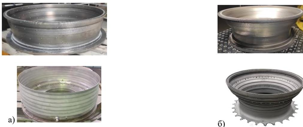
Рисунок 10 – Изготовленные крупногабаритные заготовки (сверху) и детали (внизу) КС ГТД:
