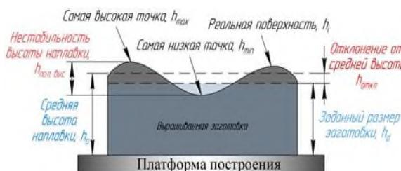
Рисунок 3 – Схема определения параметров рельефа верхней поверхности
