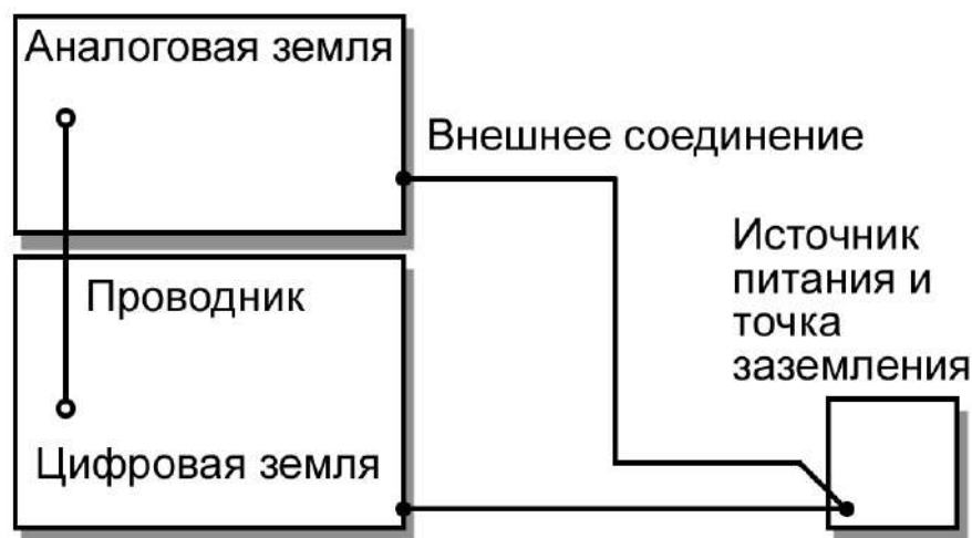
Рисунок 2.36 – Контур возвратных токов при зонировании аналоговой и цифровой схем
