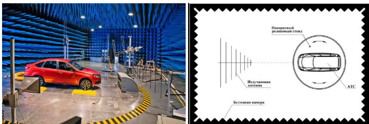
Рисунок 2.21 – Испытания на помехоустойчивость АТС в БЭК с применением излучающих антенн
