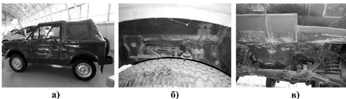
Рисунок 5.17 – Прототип ЭМС защищенного автомобиля: а) ВАЗ-2122 проекта «Река»; б), в) реализация защиты моторного отсека
