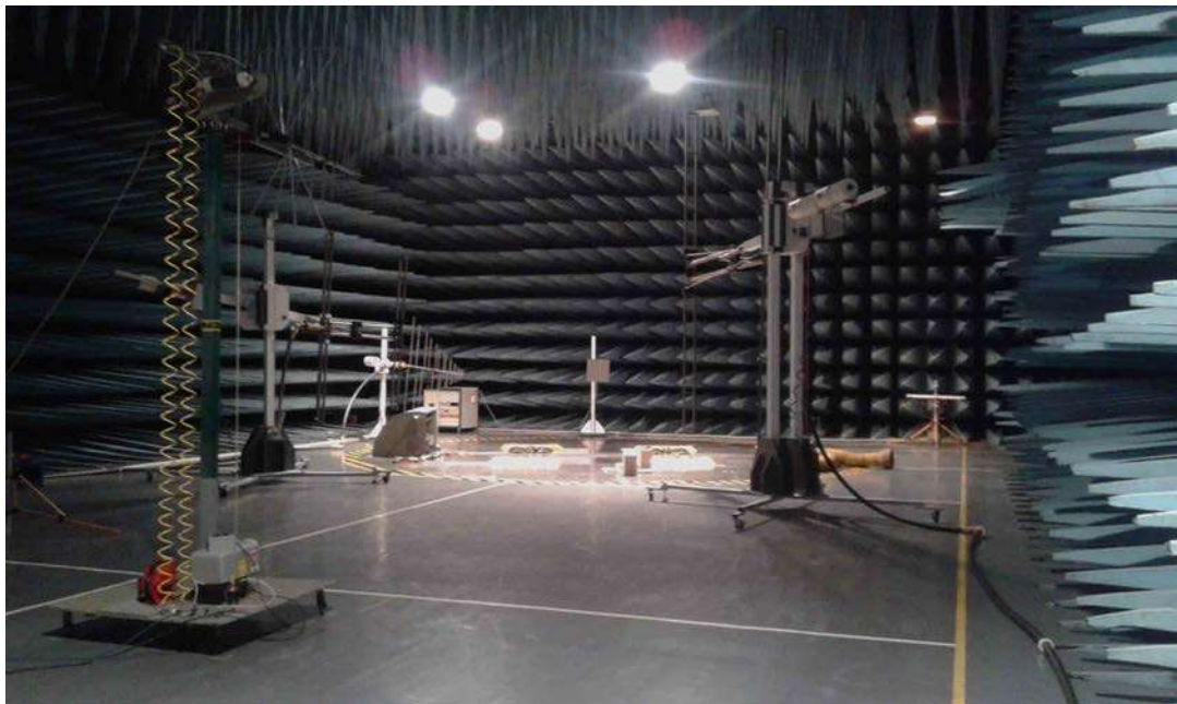
Рисунок 4.6 – Безэховая камера ЭМС лаборатории АО «АВТОВАЗ»
