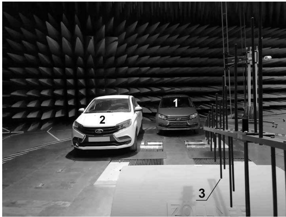
Рисунок 4.20 – Эксперимент по исследованию влияния на параметры ЭМС дорожной обстановки: 1 – исследуемый автомобиль (LADA Granta); 2 – АТС-отражатель (LADA X-RAY); 3 – источник излучения
