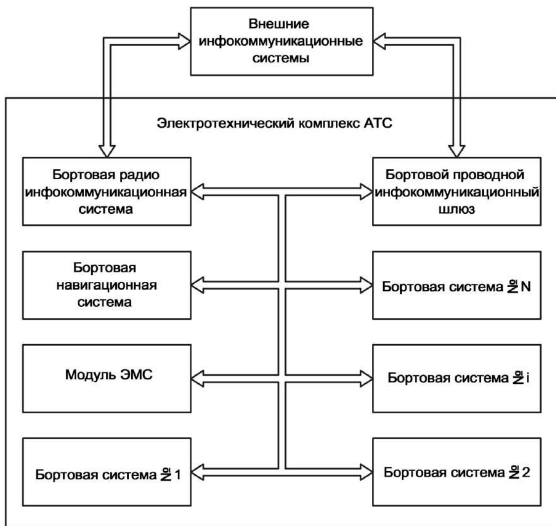
Рисунок 6.1 – Модернизированная архитектура бортового электрооборудования с интегрированным модулем обеспечения качества по параметрам ЭМС
