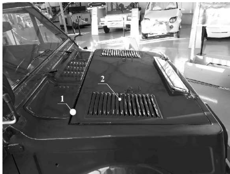
Рисунок 5.18 – Каналы проникновения ЭМП сверху: 1 – щель, образованная капотом и кузовом; 2 – воздухозаборники
