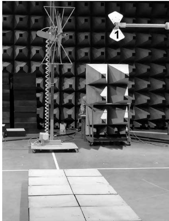
Рисунок 4.19 – Конфигурация объектов в экспериментальных исследования параметров импульсных сигналов: 1 – излучающая антенна Schwarzbeck 420NJ
