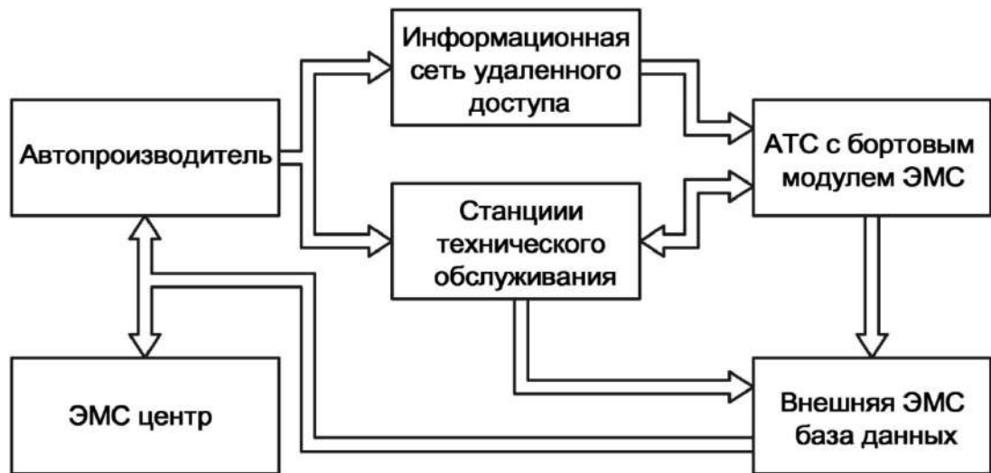
Рисунок 6.5 – Обобщенная структурная схема взаимодействия «АТС - автопроизводитель» для обеспечения качества автомобилей по параметрам электромагнитной совместимости на основе обратной связи
