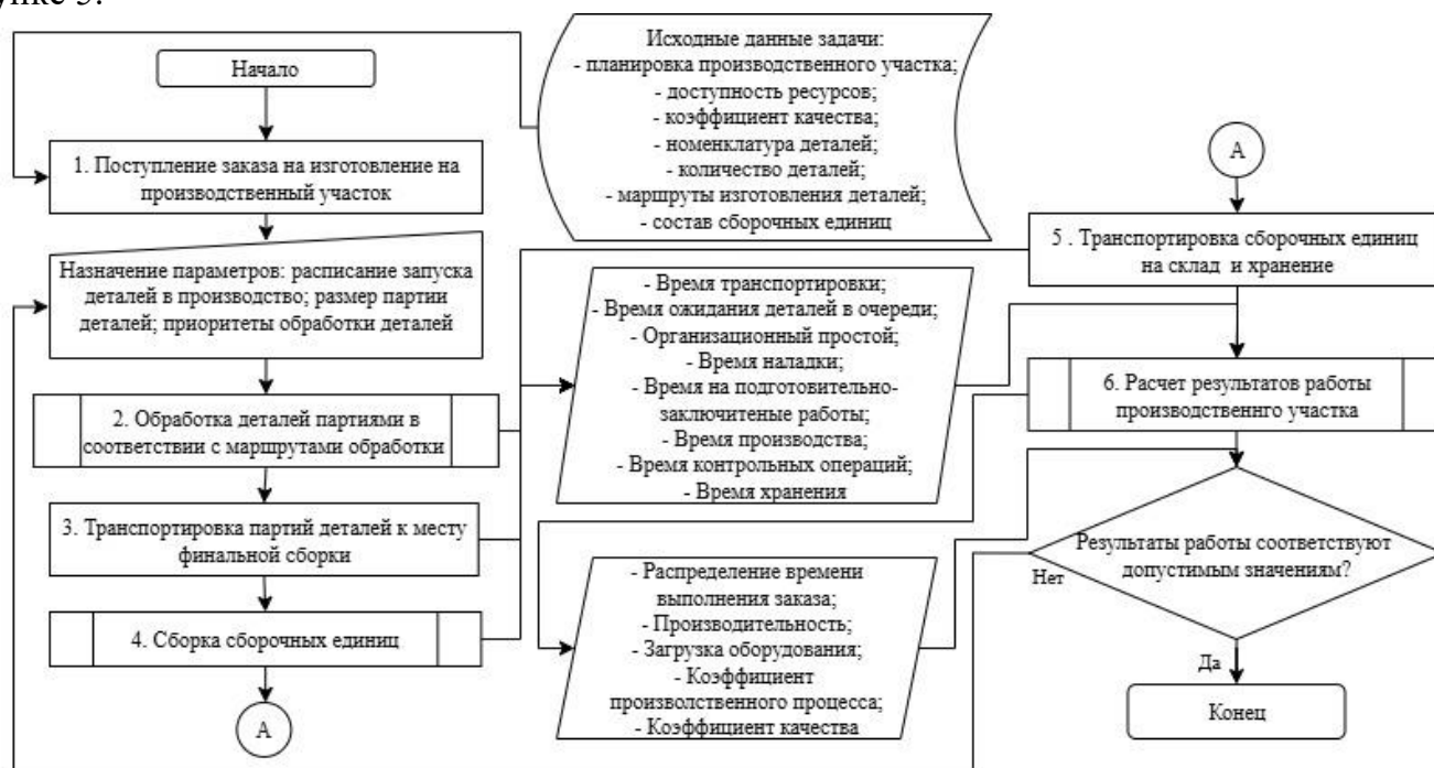
Рисунок 5 – Блок-схема алгоритма решения задач по анализу производственного сценария
