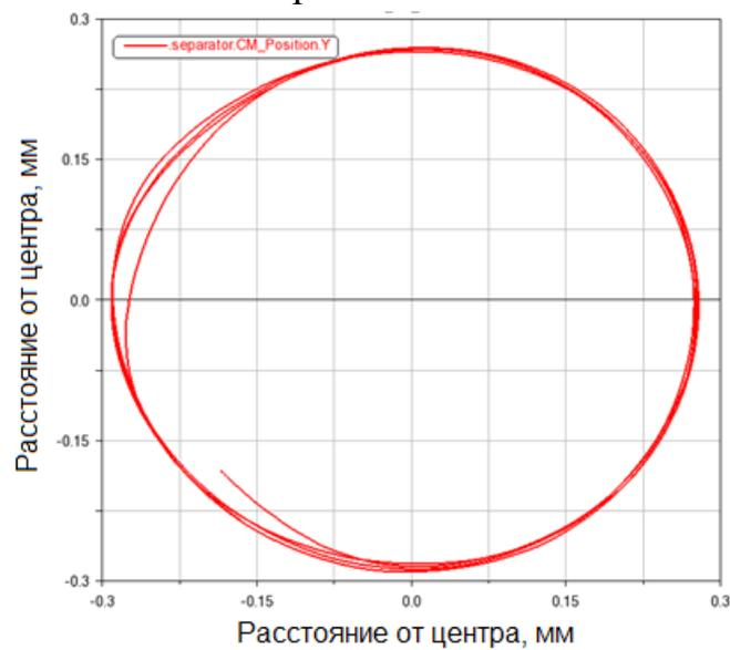
Рисунок 3.11 – Траектория центра масс сепаратора, 3-6 обороты сепаратора. Вариант расчета 11
