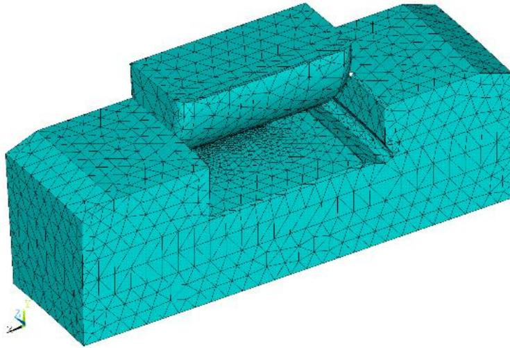
Рисунок 3.41 – Общий вид конечно-элементной модели контактного взаимодействия ролика и внутренней дорожки качения
