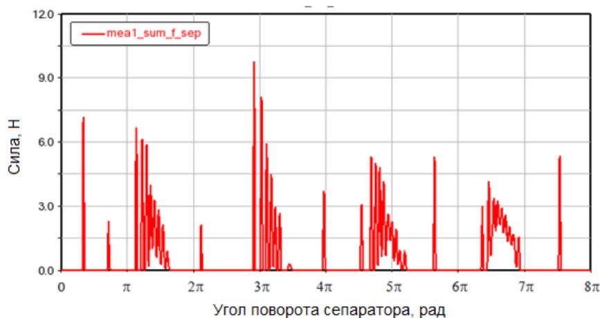
Рисунок 3.2 – Сила между рабочей поверхностью ролика и сепаратором, 3-6 обороты сепаратора. Вариант расчета 11
