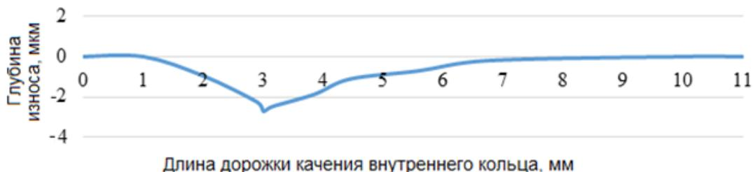
Рисунок 3.45 – Распределение глубины износа внутренней дорожки качения в варианте расчета 68 за 25000 час эксплуатации
