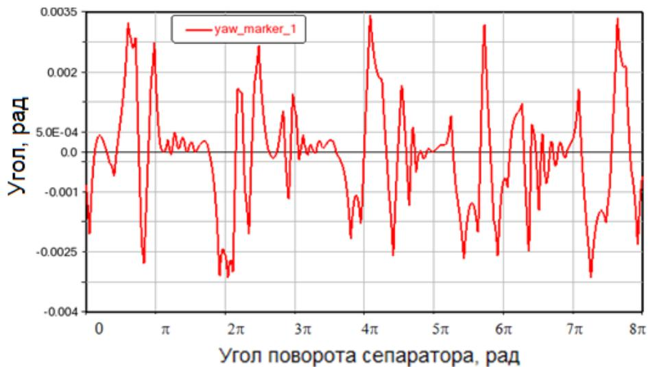
Рисунок 3.10 – Угол рысканья 1-го ролика, 3-6 обороты сепаратора. Вариант расчета 11
