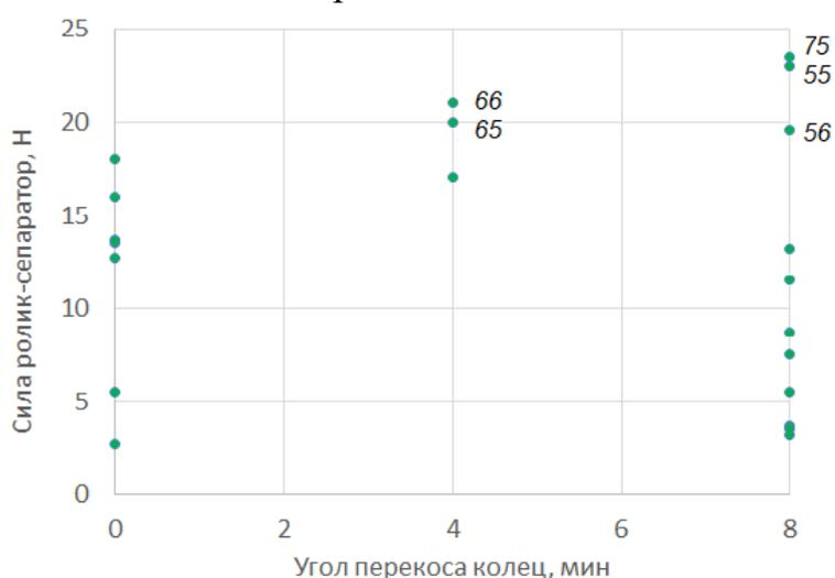
Рисунок 3.15 – Распределение максимальной нормальной силы между цилиндрической поверхностью ролика и осевой перемычкой сепаратора в зависимости от угла перекоса колец в подшипнике типоразмера 2002834 с 28 роликами
