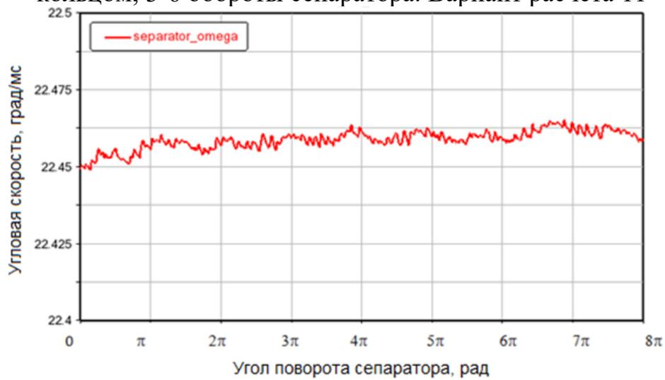
Рисунок 3.8 – Угловая скорость сепаратора, 3-6 обороты сепаратора. Вариант расчета 11
