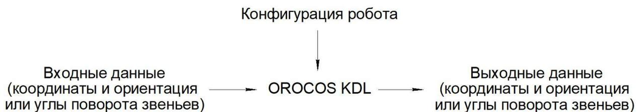
Рисунок 3.6 – Принципиальная схема работы ПО
