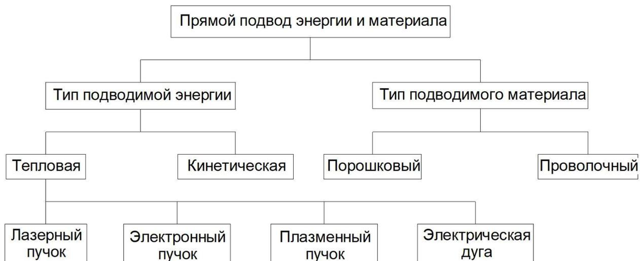
Рисунок 1.1 – Классификация технологий прямого подвода энергии и материала
