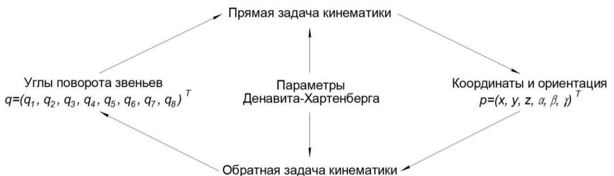
Рисунок 3.5 – Схема взаимосвязи координат и ориентации точки и углов поворота звеньев
