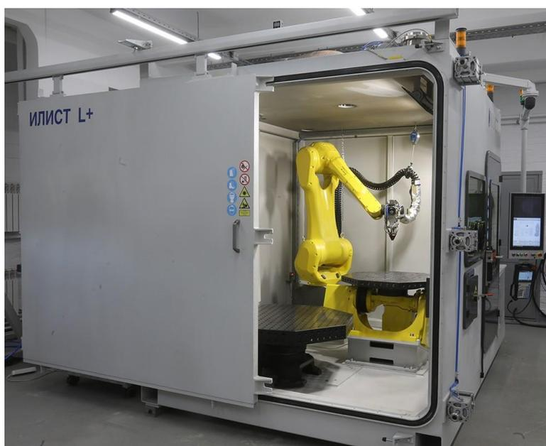
Рисунок 1.10 – Роботизированная установка прямого лазерного выращивания
