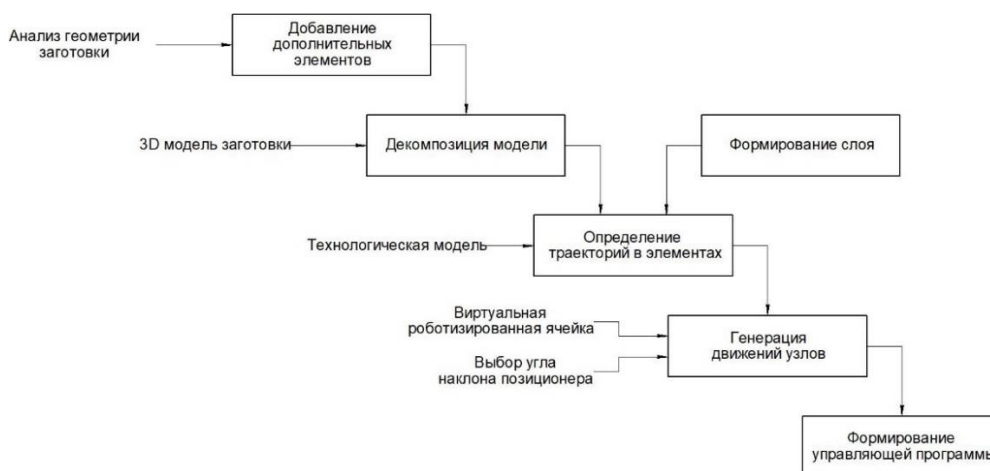
Рисунок 9 – Схема генерации управляющей программы с учётом использования позиционера
