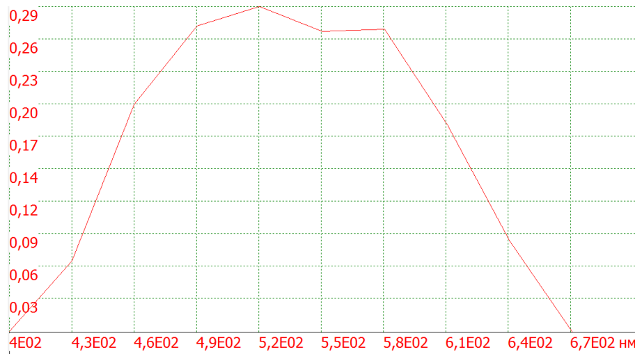
Рисунок 4.3 – Зависимость сдвига фокальной плоскости от длины волны для системы рефракционная и дифракционная линза, оптимизированная в программе HARMONY.
