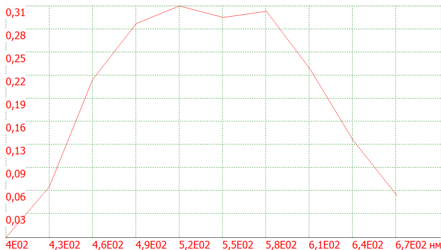
Рисунок 4.2 – Зависимость сдвига фокальной плоскости от длины волны для системы рефракционная и дифракционная линза, рассчитанная по (4.1-4.8)
