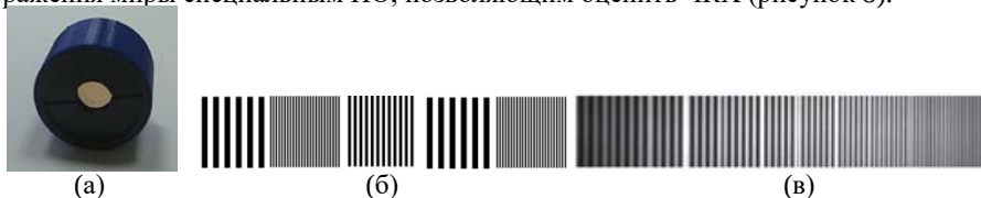
Рисунок 8 – Внешний вид рефракционно-дифракционного объектива в пластиковом корпусе (а) и мира для эксперимента с гибридным объективом (б), экспериментально полученное изображение мира (в)
