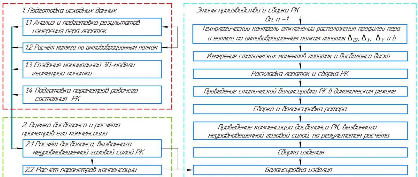
Рисунок 1 – Блок-схема метода снижения дисбаланса РК ГТД
