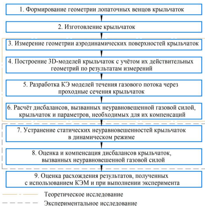
Рисунок 7 – Блок-схема верификации методики
