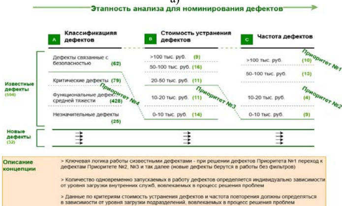
Рисунок 4 - Графическая интерпретация: введения процедуры трехуровневого фильтра выделения наиболее значимых проблем качества автомобилей в эксплуатации (а); базовых положений процедуры номинирования дефектов (б)
