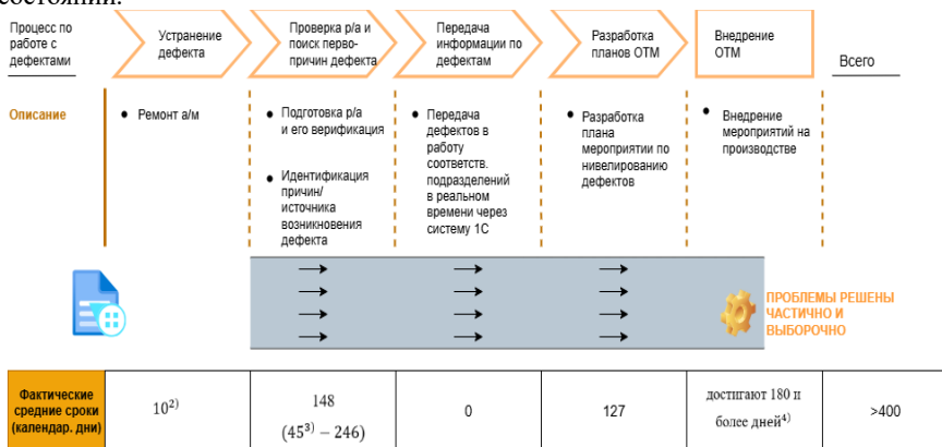
Рисунок 1 - Анализ текущего времени отработки дефектов в рамках единого процесса возврата и анализа дефектов из эксплуатации в системе менеджмента автопроизводителя
