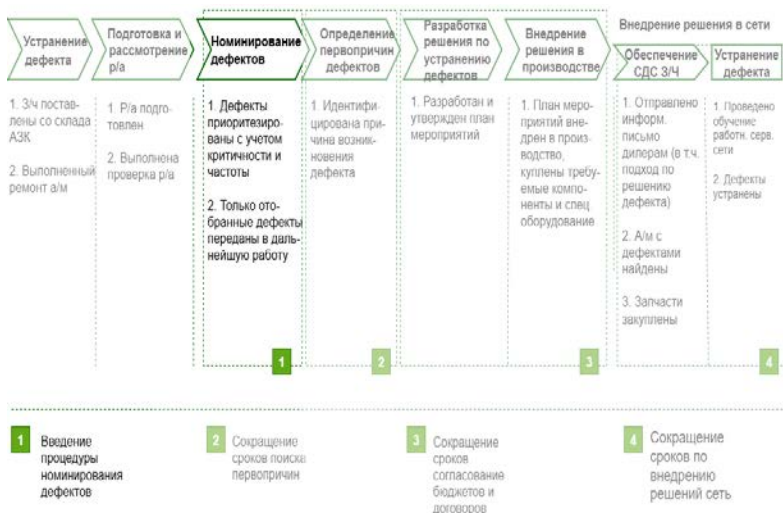
Рисунок 3 - Основные этапы процесса возврата и анализа дефектной продукции из эксплуатации в системе менеджмента автопроизводителя
