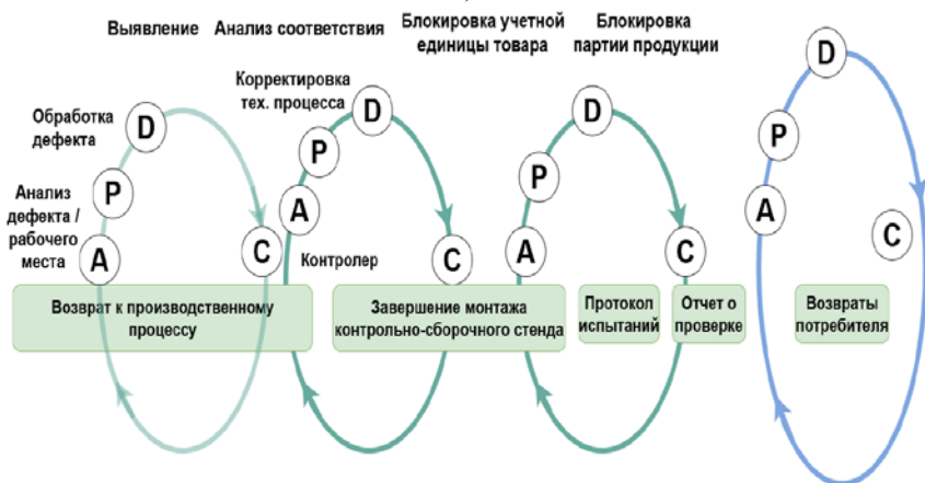
Рисунок 8 - Гарантийный процесс и графическая интерпретация цикла Э. Деминга (PDCA) в решении проблем качества продукции
