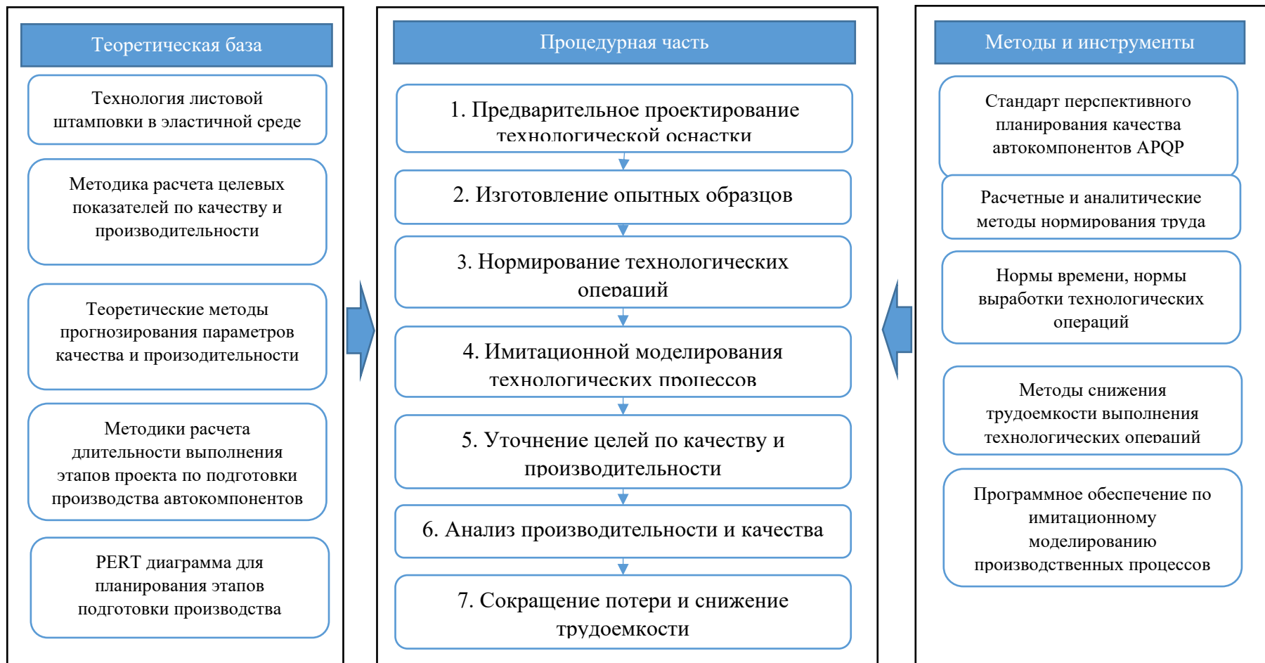
Рисунок 3.1 – Визуализация методики прогнозирования требуемого уровня производительности и качества
