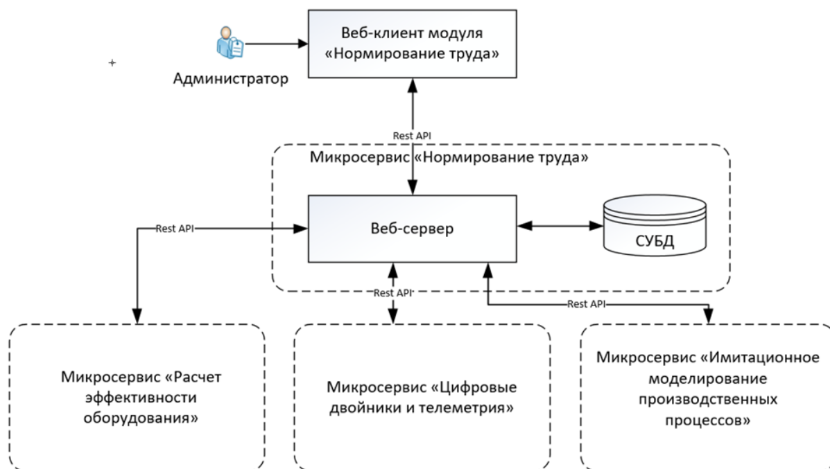
Рисунок 4.1 – Схема взаимодействия модуля «Нормирование труда» с другими модулями цифрового завода.
