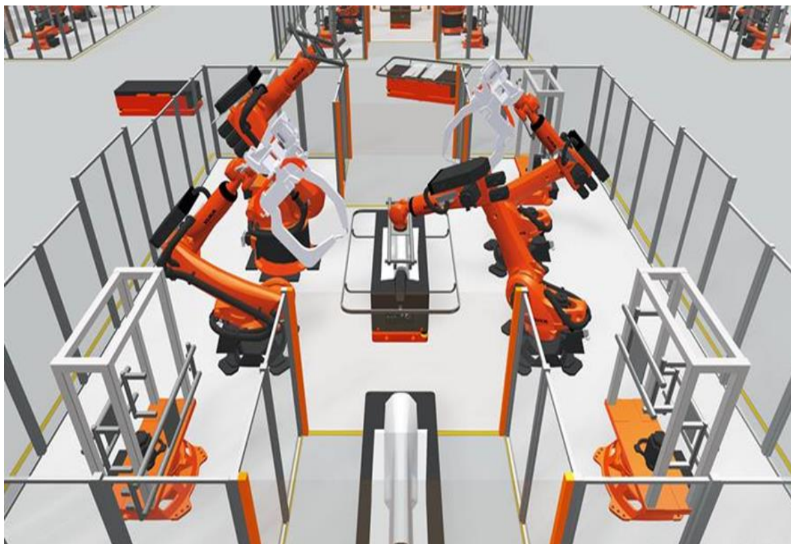
Рисунок 1.9 – Пример роботизированной сборочной ячейки
