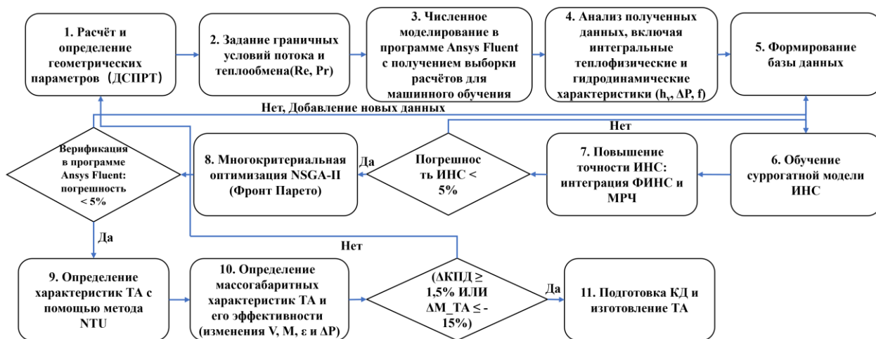
Рисунок 63 – Блок-схема метода проектирования сверхкомпактных теплообменников-регенераторов для авиационных МГТД, основанная на интеграции экспериментальных данных, численного моделирования и алгоритмов машинного обучения
