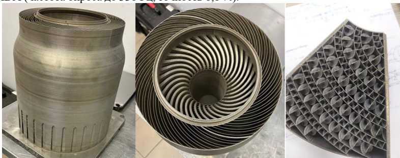
Рисунок 5 – Исследуемый теплообменник-регенератор для МГТД
