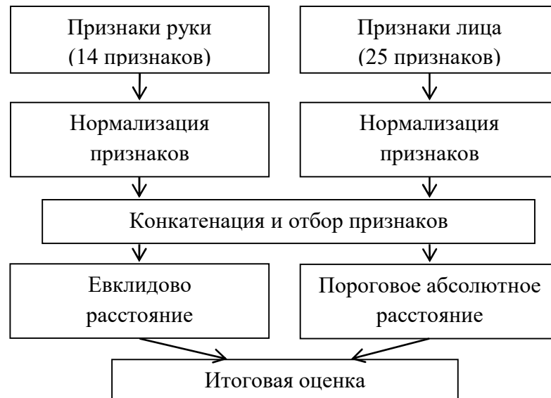
Рисунок 3.7 - Схема объединения признаков из работы [249]
