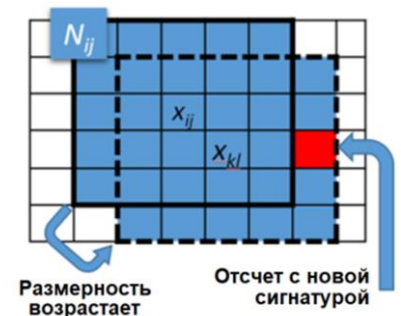
Рисунок 21 – Рост размерности в локальной окрестности
