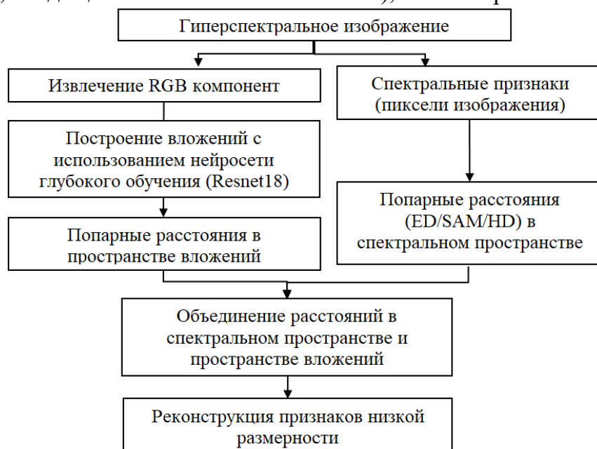
Рисунок 7 - Схема слияния спектральных признаков с признаками, извлеченными глубокими нейросетями
