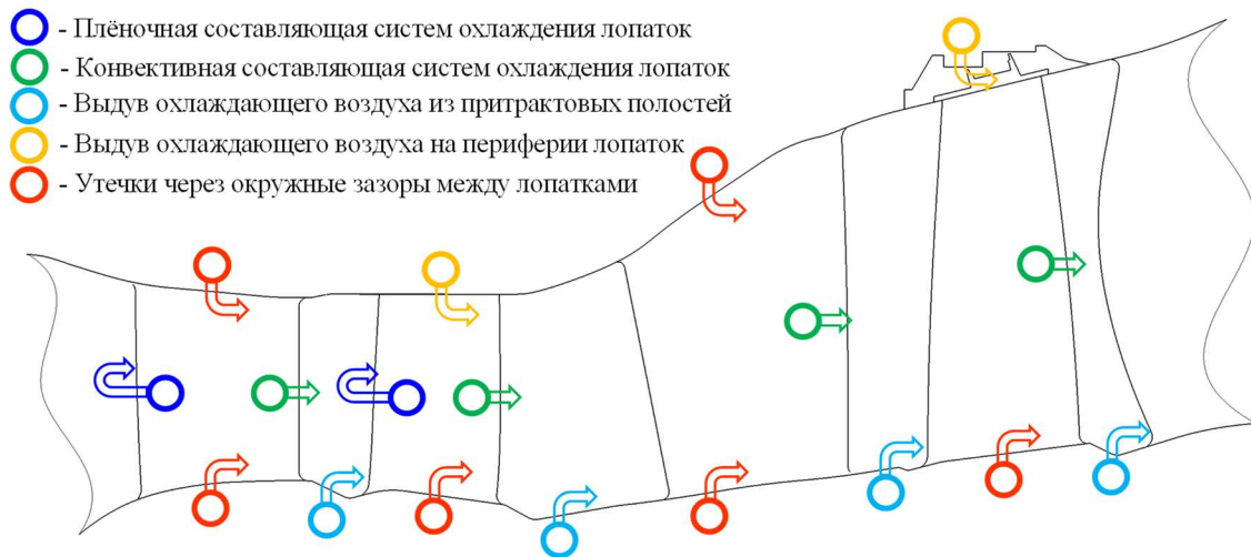
Рисунок 3.1 – Обобщённая схема системы охлаждения турбины
