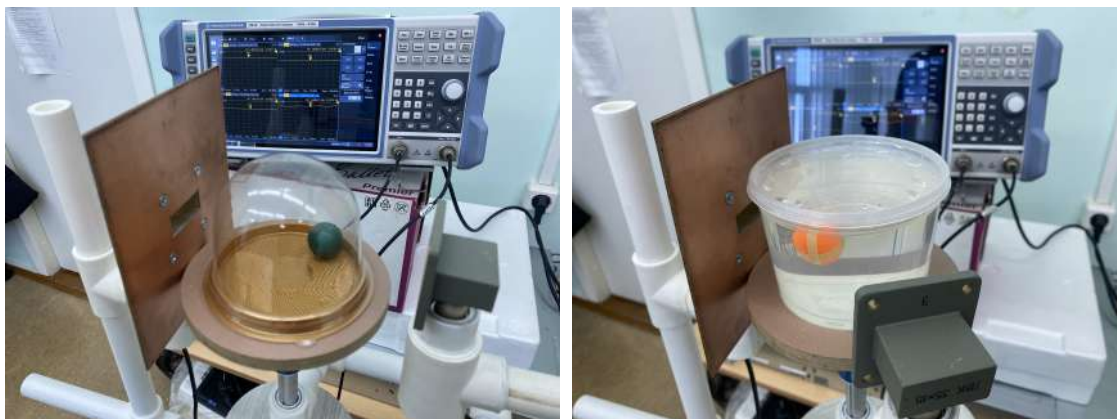
Рисунок В.3 – Измерительная установка с волноводами WR-137 и объектами с неоднородностями
