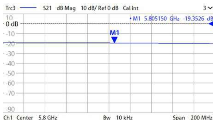
Рисунок В.8 – Значение модуля коэффициента прохождения S_{21} с применением СВЧ-абсорбера на нижней и верхней поверхностях экспериментальной установки
