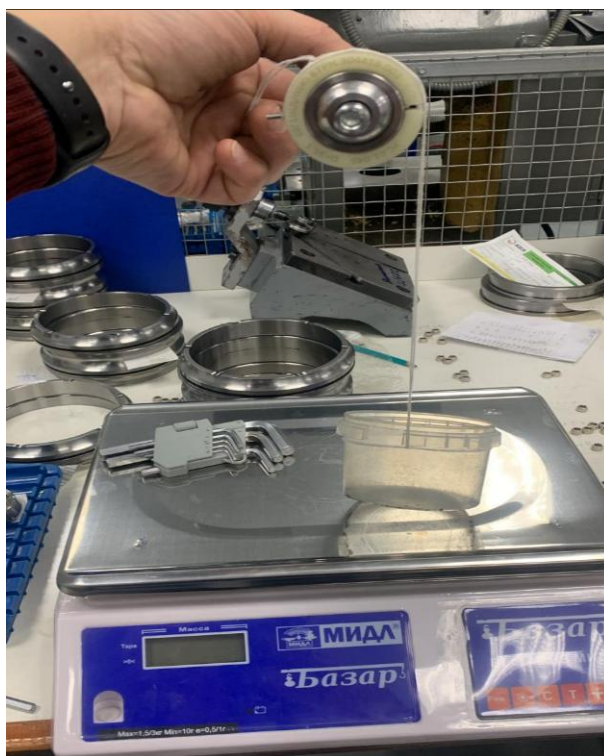
Рисунок 4.7 – Оборудование для проведения эксперимента по определению момента страгивания относительно осей Ox и Oz
