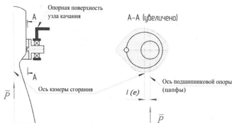
Рисунок 2.14 – Конструктивная схема компенсации момента асимметрии эксцентриковой втулкой
