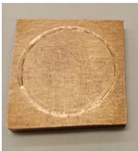
Рисунок 3.10 – Внешний вид поверхности образца без покрытия после эксперимента
