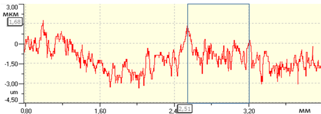
Рисунок 4.26 – Профиль поверхности кольца в паре шар из стали ШХ-15 и кольцо с покрытием 94% серебра и 6% графита
