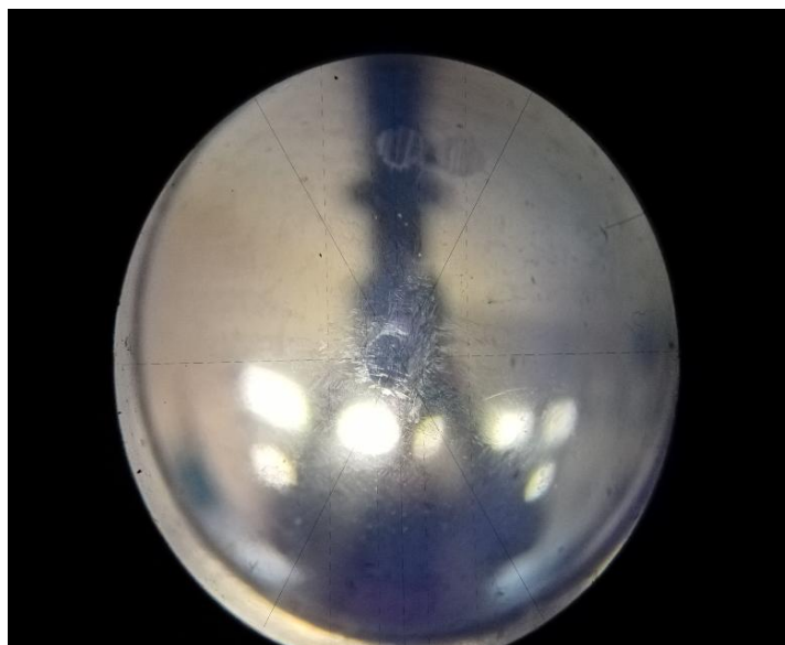
Рисунок 4.33 – Вид поверхности шара из стали ШХ-15 со следами износа после пробега 100 000 м по кольцу с покрытием 94% серебра и 6% графита
