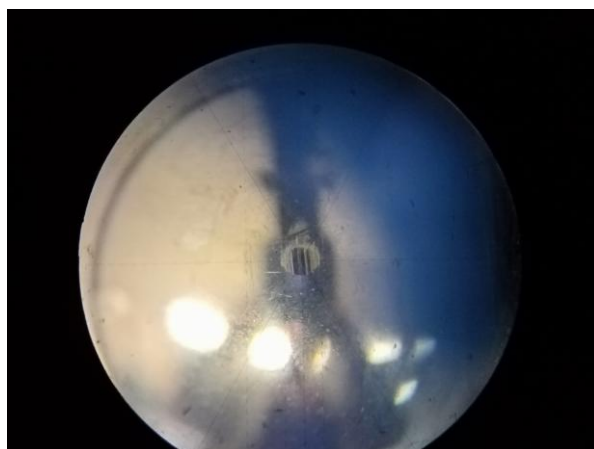
Рисунок 4.32 – Вид поверхности шара из стали ШХ-15 со следами износа после пробега 14000м по кольцу с покрытием 94% серебра и 6% дисульфида молибдена
