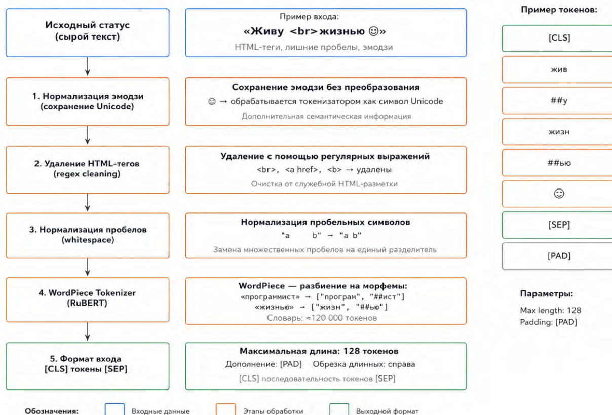
Рисунок Б.3 – Конвейер предобработки текстовых данных для модели RoBERTa
