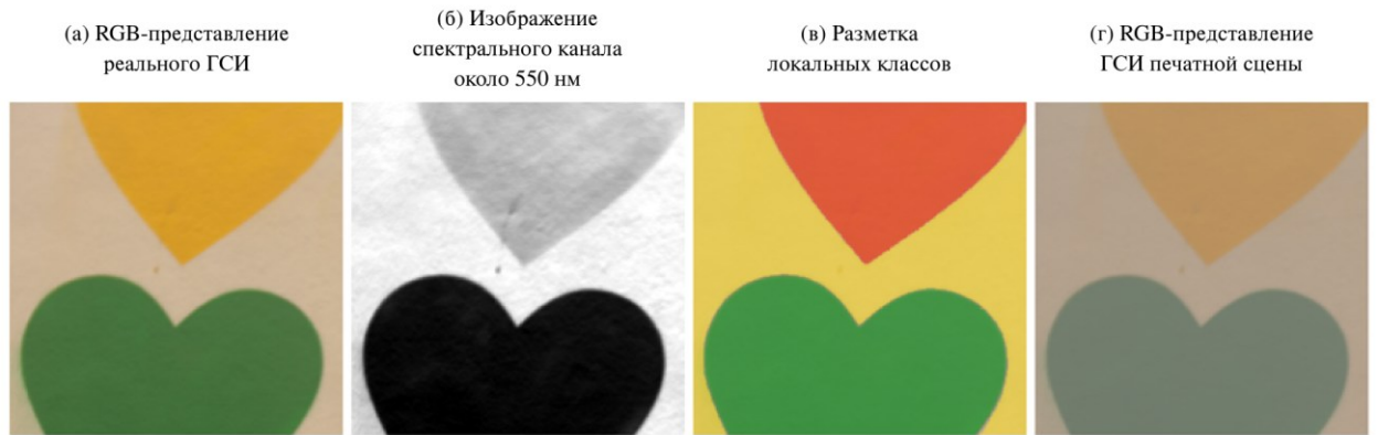
Рисунок 1.23 – Фрагмент ГСИ test_frag0052: RGB-представление (а), изображение спектрального канала около 550 нм (б), выделенные локальные классы (в) и RGB-представление соответствующего ГСИ печатной сцены (г)
