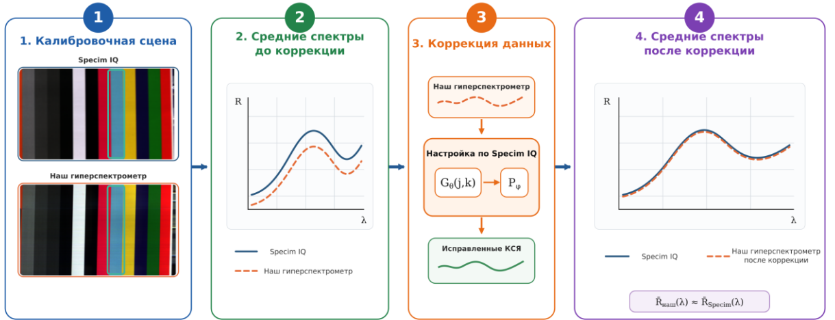
Рисунок 3.6 – Схема межприборного согласования среднего спектра класса c для положений j вдоль изображения щелевой диафрагмы
