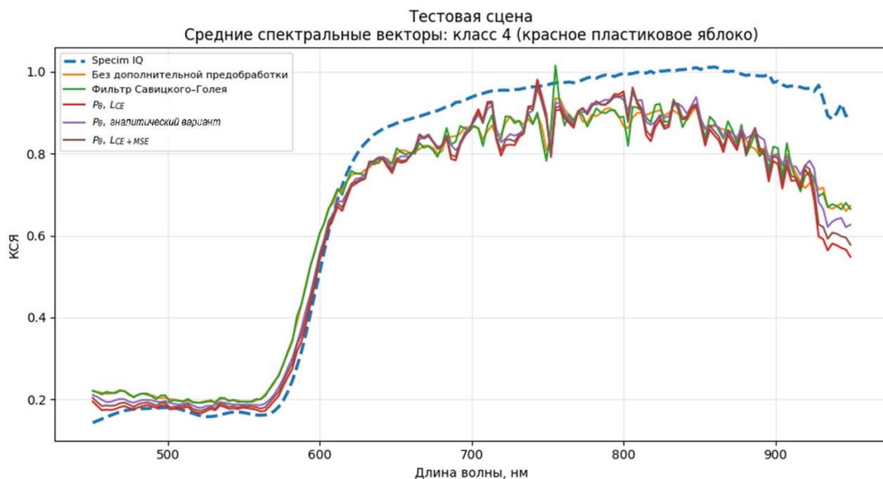
Рисунок 2.18 – Средние спектральные векторы класса 4 тестовой сцены для опорного ГСИ Specim IQ и сравниваемого ГСИ при различных вариантах предобработки (пример отдельного запуска: окно 5, \lambda = 0,1 )
