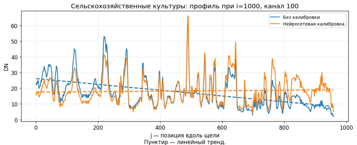
Рисунок 3.16 – Пространственный профиль значений элементов ГСИ вдоль щели при i = 1000 в спектральном канале 100 до и после коррекции.
